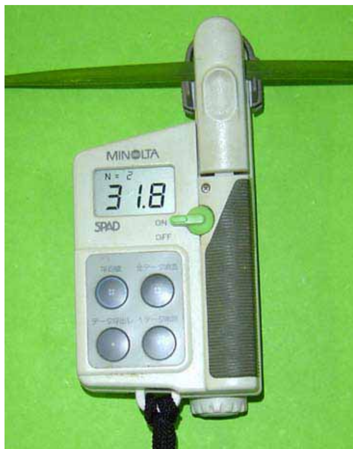
Fig. 2. A chlorophyll meter or SPAD meter.
